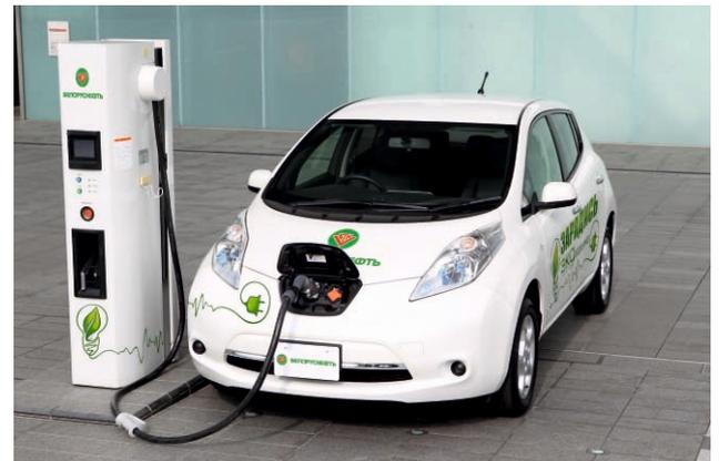
**Зарядный комплекс** – предназначен для зарядки электромобилей, продолжительность которой может варьироваться от 20 минут до 8 часов в зависимости от типа станции и установленных в электромобиле зарядных устройств.
