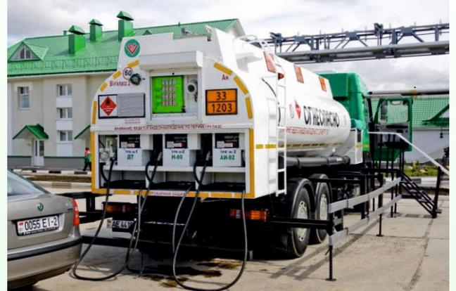
**Передвижная АЗС** – автозаправочная станция с оборудованием, размещенным на шасси транспортного средства. Осуществляет реализацию нефтепродуктов на стационарных АЗС и на специализированных площадках в населенных пунктах с минимальным объемом потребления.
